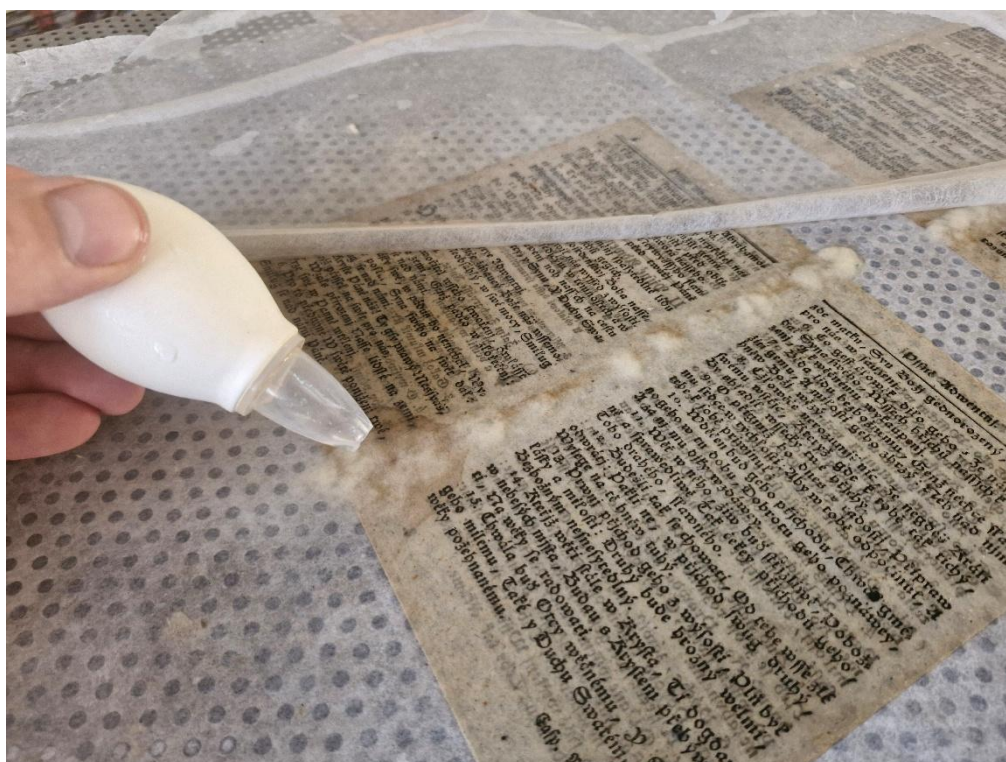
Doplňanie strát papierovej podložky pomocou dolievanej zmesi.
